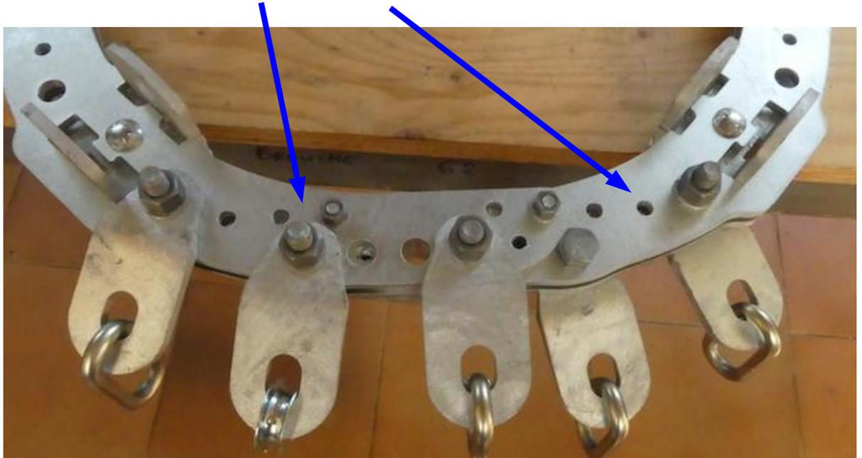
4.5 - Exemple de montage pour une tyrolienne de grande longueur, générant une traction élevée.
